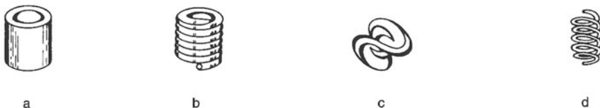
Abb. 167 a-d. Füllkörper-Formen. a) Glasring (Raschig-Ringe); b) Wendeln; c) Sattelförmige; d) Spirale
