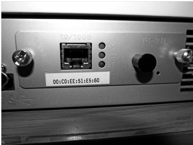
Abbildung 4.1 Aufkleber mit MAC-Adresse an einem internen Printserver
