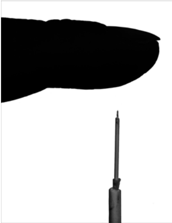
Abbildung 2.39 Verletzungsgefahr an offenen LWL-Kabelenden
