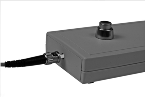
Abbildung 2.41 Eigenbau-LWL-Tester mit Adapterkabel ST
