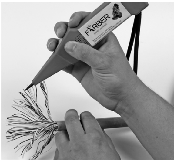
Abbildung 2.30 Arbeiten mit dem Tastkopf an einem Adernbündel
