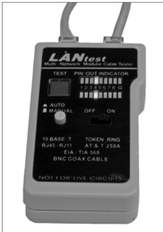
Abbildung 2.26 Prüfung der Patchkabel
