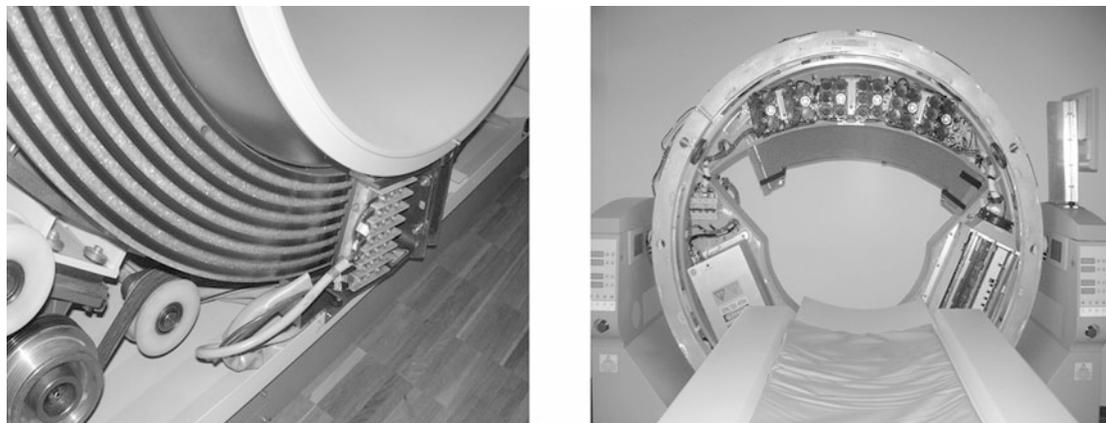
**Abb. 3.14:** Realisierungen der Energieübertragung auf die sich kontinuierlich drehende Abtasteinheit. Beim Siemens Somatom AR.T (links) findet die Schleifringtechnologie Anwendung. Beim kompakten mobilen Tomographen Philips Tomoscan M (rechts) findet eine Akkumulatoranordnung Anwendung.
