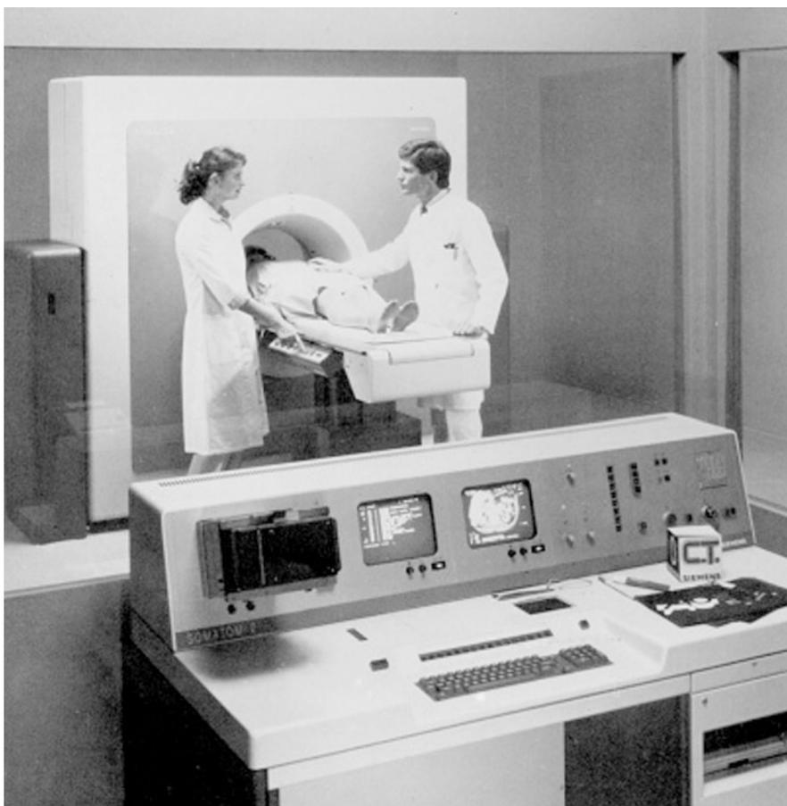
**Abb. 3.10:** Typischer Ganzkörperscanner aus dem Jahre 1981. Die Siemens Somatom-Familie DR. Diese dritte Generation von Computertomographen besaß ein Messfeld von etwa 53 cm Durchmesser. Bei bis zu 512 Festkörperdetektoren waren Aufnahmezeiten für eine  $360^\circ$ -Drehung von 3 Sekunden möglich (mit freundlicher Genehmigung von Siemens Medical Solutions).
