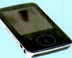
Das **Navigationssystem** ist ein elektronisches Gerät, das den Nutzer zu einem bestimmten geographischen Ziel führt. Zunächst ermittelt das Navigationssystem den aktuellen Standort. Dann wird die ideale Fahrroute zum Ziel errechnet und angezeigt. Das Navigationssystem berücksichtigt bei der Routenplanung auch aktuelle Verkehrsinformationen.
