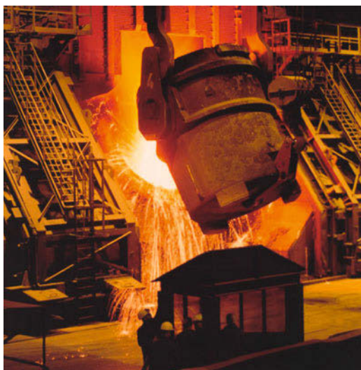
Abb. 5: Konverter im Stahlwerk Arcelor Mittal, Eisenhüttenstadt, Foto: Weitze/Berger: Werkstoffe 2013:32
