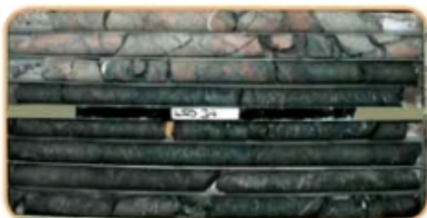
نمونه‌های سنگ (مغزه‌گیری) از گمانه‌های اکتشافی
